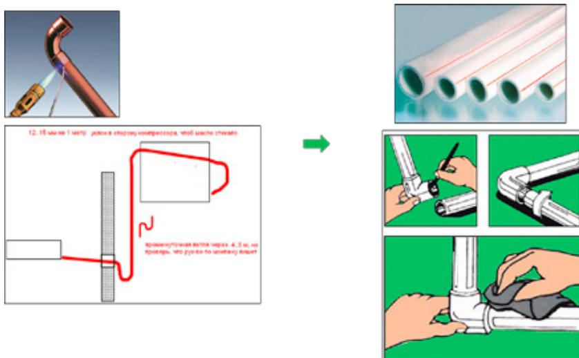
Рис. 10. Отличие в монтаже трубопроводов классической системы выносного холода и системы Ostrov Green Technology
