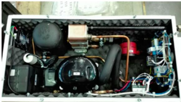
Рис. 6. Устройство индивидуального агрегата горизонтального исполнения Ostrov Green Technology
